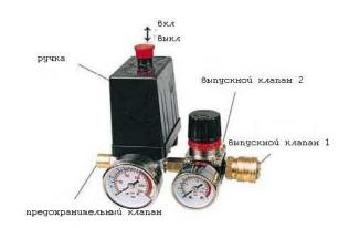
Откройте выпускной клапан, установите выключатель в позицию «вкл.», перед использованием дайте компрессору поработать 10 минут без нагрузки, чтобы обеспечить смазку движимых частей.
